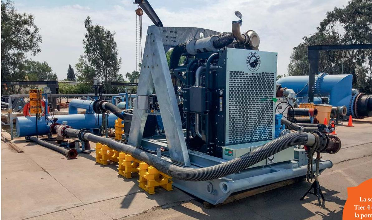
La solution Scania Tier 4 (Final) motorise la pompe que Rain for Rent utilise dans une raffinerie de pétrole au Texas.
